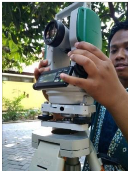
Gambar 6.9. Memasang theodolit pada tripot
