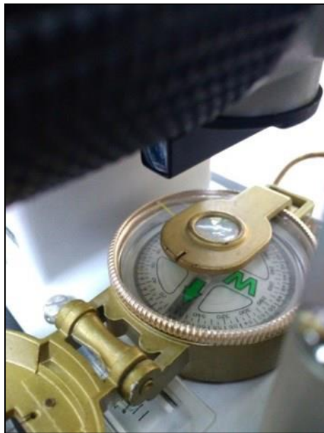
Gambar 6.13. Menggunakan kompas untuk setting arah utara
