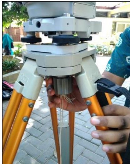
Gambar 6.10. Mengencangkan baut pesawat pada tripod
