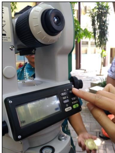
Gambar 6.21. Setting sudut vertikal
