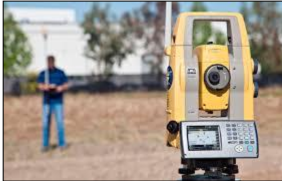
Gambar 2.4. Pengukuran dengan total station
