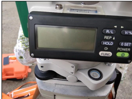
Gambar 6.17. Posisi nivo sempurna
