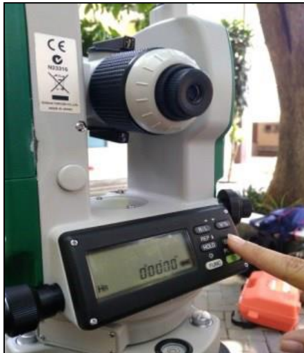
Gambar 6.20. Setting sudut horizontal
